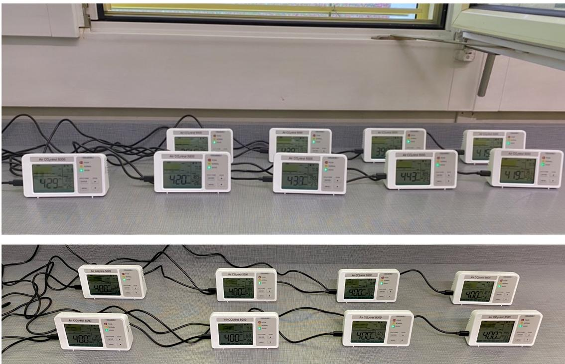
Abb. 27 Messgeräte Air CO2ntrol 5000 vor (oben) und nach (unten) der CO<sub>2</sub>-Kalibrierung auf den (nicht anpassbaren) Sollwert von 400ppm.
