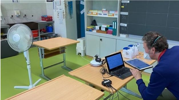
Während dessen Freisetzung waren zur gleichmässigen Verteilung des Aerosols drei Ventilatoren im Betrieb. Nach einer kurzen Ruhephase wurden die Luftreiniger angeschaltet.
